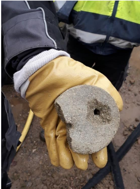
Jetting-Versuch an USM-Kern (Fraunhofer Bochum)
